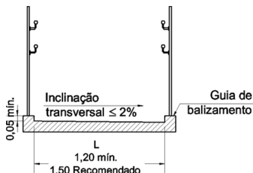
Figura 80 — Inclinação transversal e largura de rampas - Exemplo
