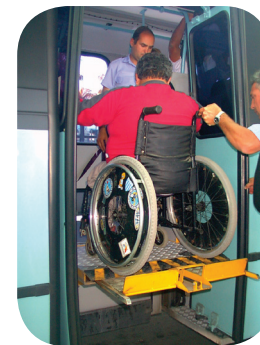
O ônibus com plataforma elevatória permite às pessoas em cadeira de rodas ou com problemas de locomoção o acesso ao transporte público. Fonte: Acervo autoras.
